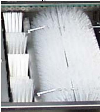
Im Durchlaufverfahren werden die Bleche in drei Zonen hygienisch gereinigt und getrocknet. Anschließend werden sie mit der optionalen Sprühbeölung automatisch geölt und zum Bediener zurückgeführt. Verwendbare Blechgrößen:
